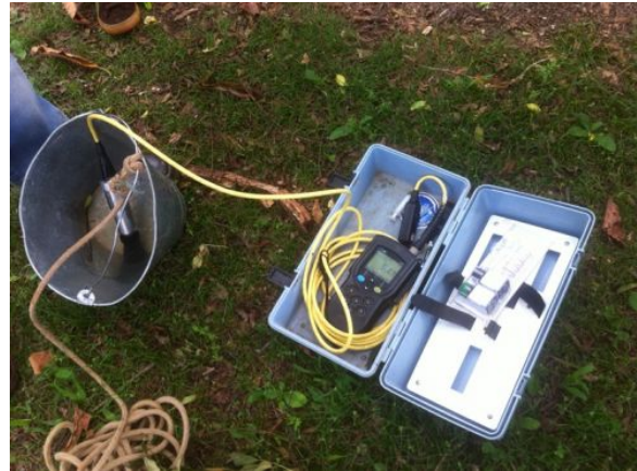
Figura 4: Medição de OD através de oxímetro de luminescência óptica de campo
